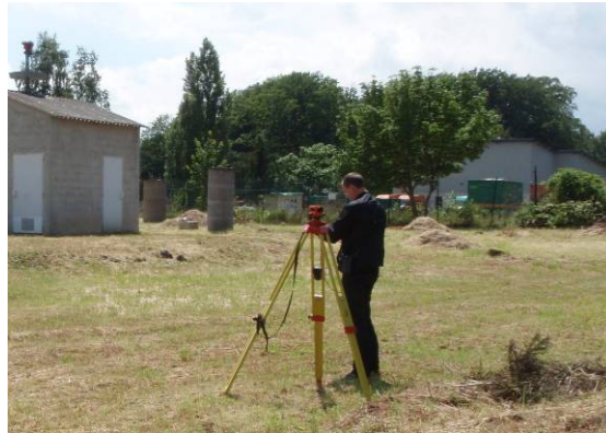
Illustration 76 - Contrôle des repères de niveau des puits Gargan 1 et 2.
