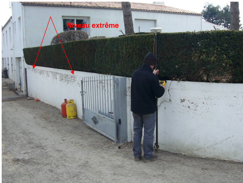
Figure 7 : Mesure d'un niveau d'eau extrême à Charron
