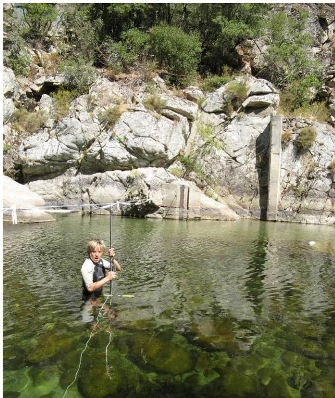
*Illustration 24 – Exemple de section sur laquelle est mesurée le champ de vitesse avec le Nautilus (Liamone, 60 m)*
