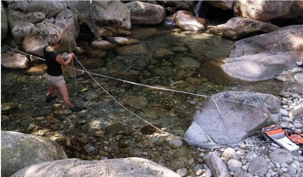
*Illustration 23 – Exemple de section sur laquelle est mesurée le champ de vitesse avec le Nautilus (Restonica, 935 m)*
