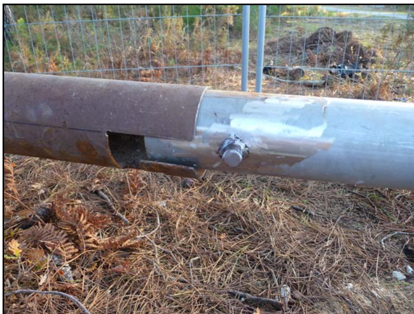
Illustration 11 : Tube baïonnette pour la pose de la crépine
