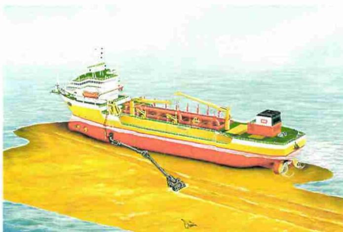
Figure 23 : schéma d'une drague aspiratrice en mouvement (source : http://www.dsc.tudelft.nl )
