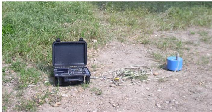
*Illustration 40 - Dispositif H/V utilisé à Mayotte (à gauche : la station d'acquisition et à droite : le sismomètre tridimensionnel Lennartz 5 secondes)*
