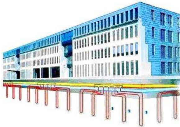
Illustration 6 : Représentation schématique des pieux énergétiques (www.geothermal-energy.ch)
