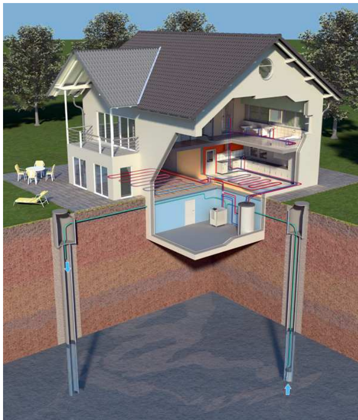
Illustration 7 : Représentation schématique d'une pompe à chaleur sur nappe ( www.novenergie.com )
