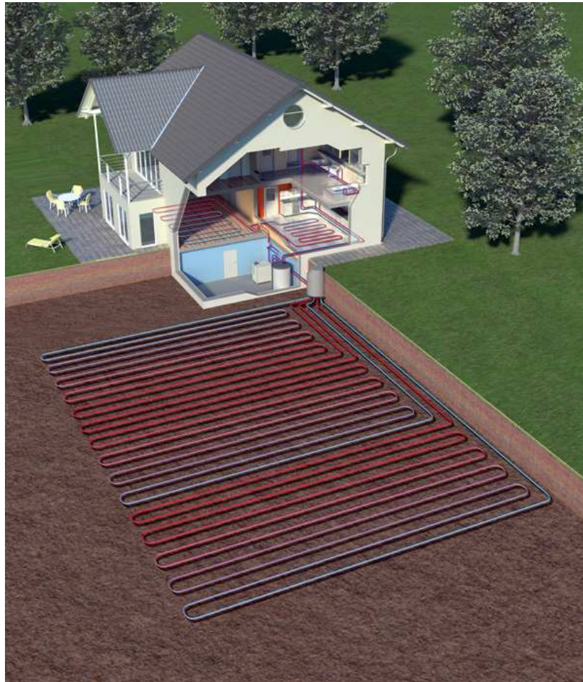
Illustration 4 : Représentation schématique de capteurs horizontaux (www.novenergie.com)
