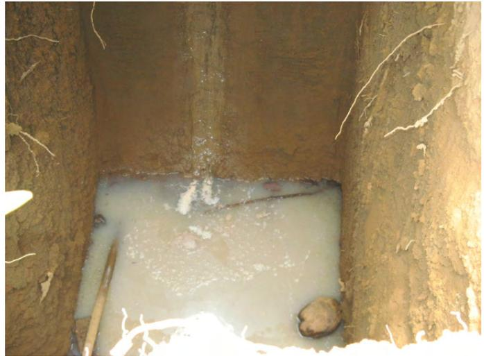
*Illustration 53 : Fosse d'évacuation des eaux usées située à 90 m à l'amont du forage Kawéni F2. Sur la photo de gauche, on aperçoit le tuyau d'évacuation des eaux usées qui part de la construction en tôle (photos BRGM du 21 septembre 2009).*
