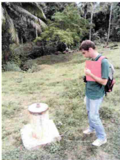
Illustration 14. Le piézomètre de Béja 2 (reconnaissance du 17 septembre 2009)
