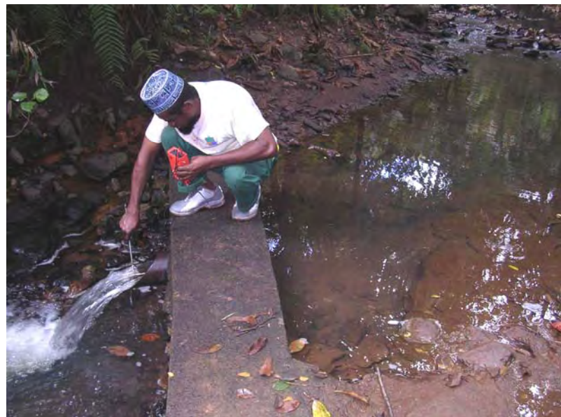
Illustration 11 - Jaugeage du Mro Oua Andrianabé au seuil G12H (photographie DAF de Mayotte antérieure à 2008)
