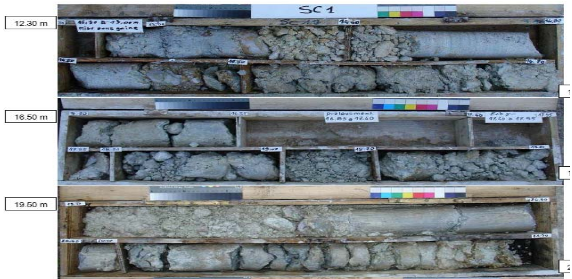
Figure 10 : Carottes reconstituées après forage du sondage SC1
