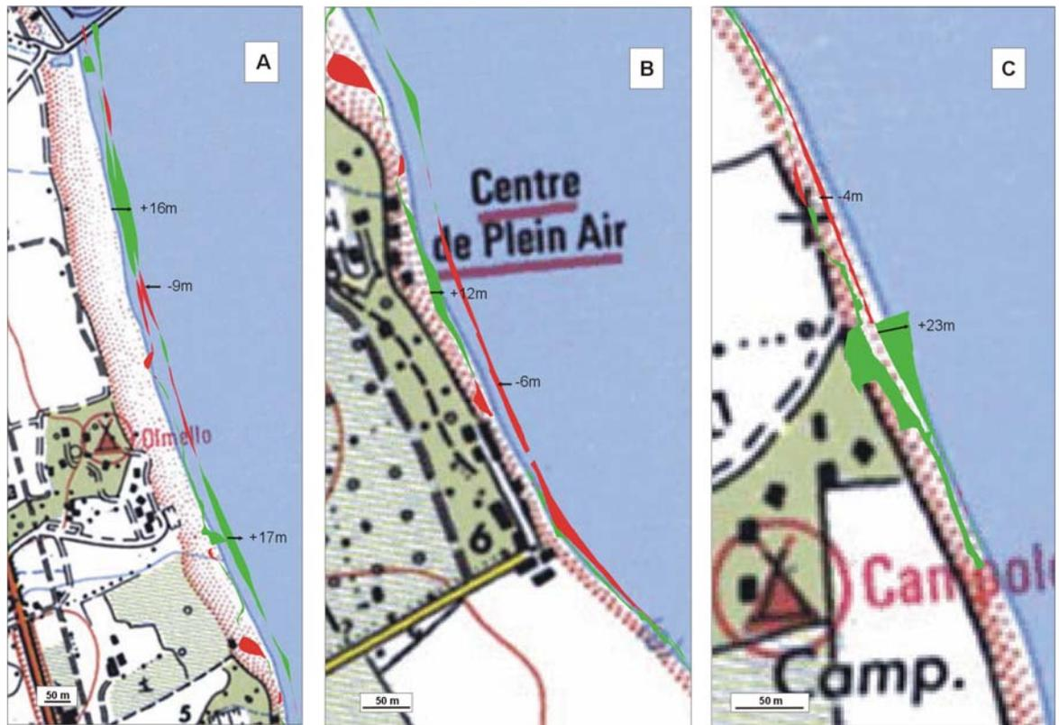
Illustration 66 : Site de Campoloro Sud – 22/06/2005 – 15/05/2008. Agrandissement sur les secteurs sud de la digue du port (A), du centre de plein air (B) et de l'épi géotextile de Prunete (C). En rouge, les surfaces en érosion ; en vert, les surfaces en accrétion.
