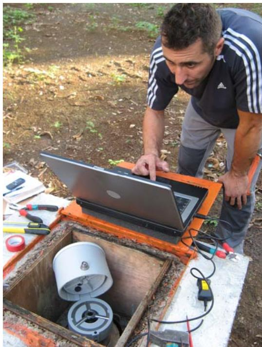
*Illustration 19. Instrumentation du piézomètre de Digo (photographie BRGM du 21 octobre 2009)*
