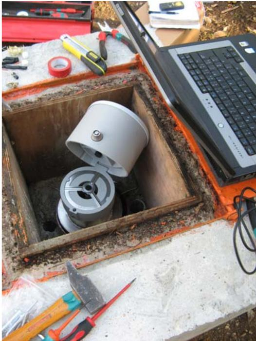
*Illustration 2. Détail de la pose des stations OTT Orhéus Mini sur les nouveaux piézomètres 2008-2009 (cas du piézomètre de Digo, BSS 12306X0053/PZ5, photographie BRGM du 21 octobre 2009)*
