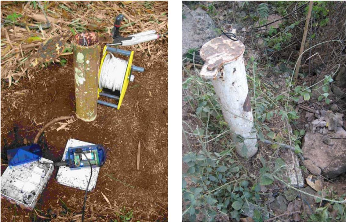
*Illustration 21. Photographies des têtes d'ouvrage de Kahani 1 8" (à gauche) et de Kawéni 1 8" (à droite). Les capots sont détruits et n'assurent plus la sécurité des ouvrages et des instruments de mesure.*
