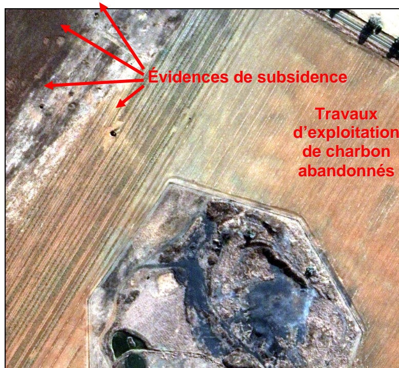
Figure 27 - Détection visuelle de subsidences de surface liées à d'anciennes exploitations de charbon à partir d'une image IKONOS.
