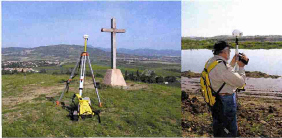
Figure 7 : mesure D-GPS à l'aide de 2 stations d'acquisition. La base D-GPS a été positionnée sur une borne géodésique IGN distante à 5 km à vol d'oiseau du site d'étude. Les valeurs sont acquises par le GPS mobile. Le traitement des données sur le code (position des satellites) et sur la base permet d'avoir une précision d'ordre centimétrique en x, y et z. Dans les zones à couvert végétal dense, l'acquisition des données est difficile (satellites masqués) ce qui oblige à dégrader la précision des données.
