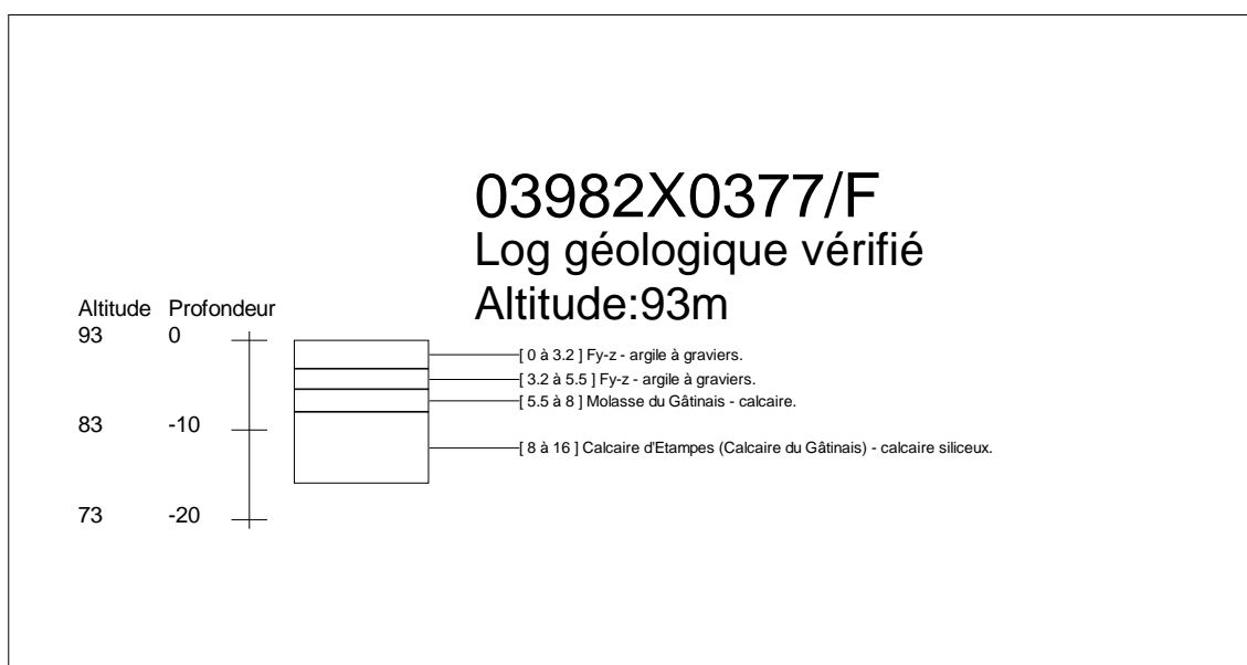
Illustration 32 - Log validé du forage 03982X0377/F.
