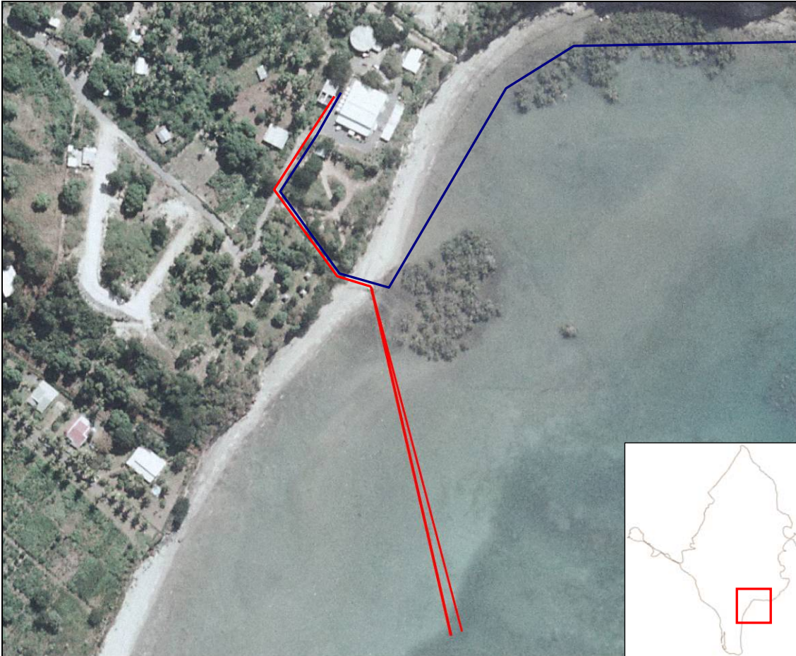
Illustration 1 : Localisation de l'usine de dessalement de Petite-terre et tracé du drain de captage (rouge) et de la conduite d'évacuation des saumures (en bleu, qui se jette extérieur récif). Le relevé est réalisé d'après les observations de terrain (support orthophoto IGN – 2003).
