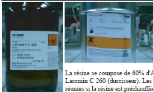
La résine se compose de 60% d'Araldit Dy 026SP mélangée à 40% de Laromin C 260 (durcisseur). Les meilleures conditions de fluidité sont réunies si la résine est préchauffée à 50°C.
