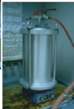
Une fois la cellule montée, elle est placée sur une plaque préchauffée à 50°C puis connectée à une pompe à vide.
