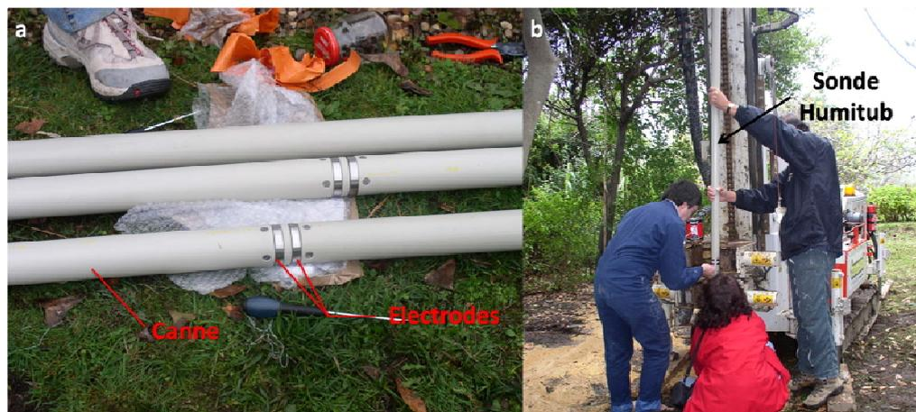
Illustration 6 : a : Détail de la sonde Humitub : électrodes et canne ; b : mise en place de la sonde Humitub
