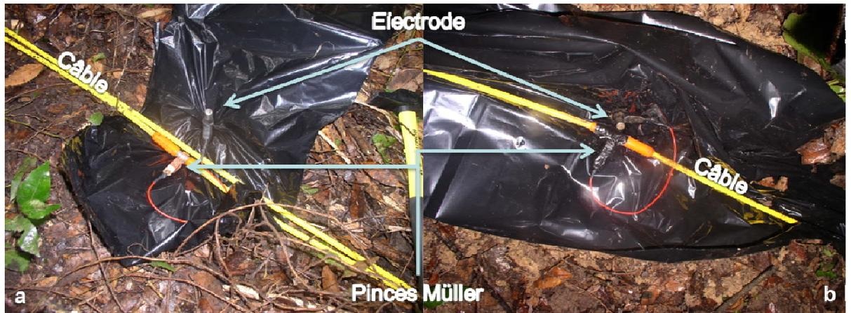
*Illustration 14 : Dispositif de tomographie électrique : connexion des électrodes au câble : a. avant protection des connectiques b. protection avec un adhésif thermocollant imperméable*
