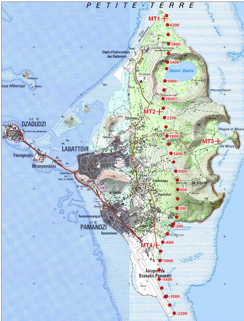
Figure 1 - Localisation du panneau électrique (les positions d'électrode sont présentées par les points rouges) et des stations MT (croix rouges).
