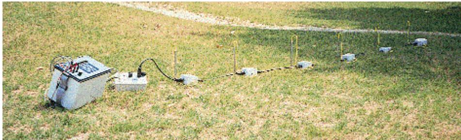
Figure A1.1 - Système multi-électrodes de IRIS-Instruments, qui permet l'automatisation des séquences de mesure de panneaux électriques.
