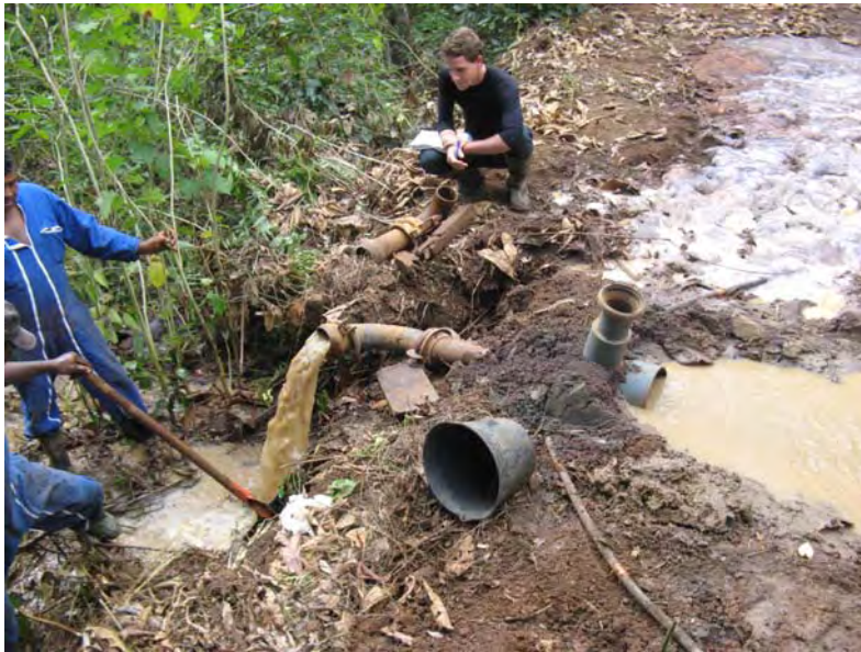
Illustration 8. Essai au soufflage à 60 m de profondeur. Le débit mesuré avoisine 5 L/s
