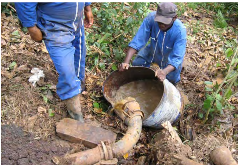
Illustration 10. Dispositif de mesure des débits au soufflage au moyen d'un fût de 200 L.
