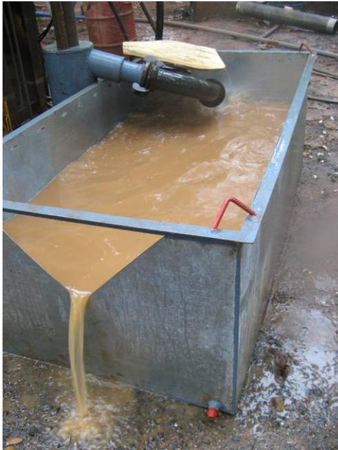
Le débit de la cuve est alors mesuré au niveau du déversoir à l'aide d'un seau de contenance connue. Cette méthode a des limites : en cas de débit important, des fuites apparaissent au niveau de la tête de forage et la turbulence dans la cuve crée des remous et des projections qui favorisent les pertes et ne facilitent pas la mesure.
