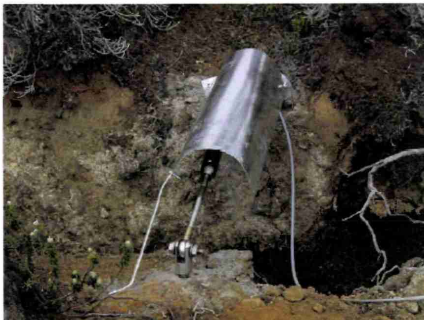
Illustration 28 – Exemple de capteur extensométrique en place
