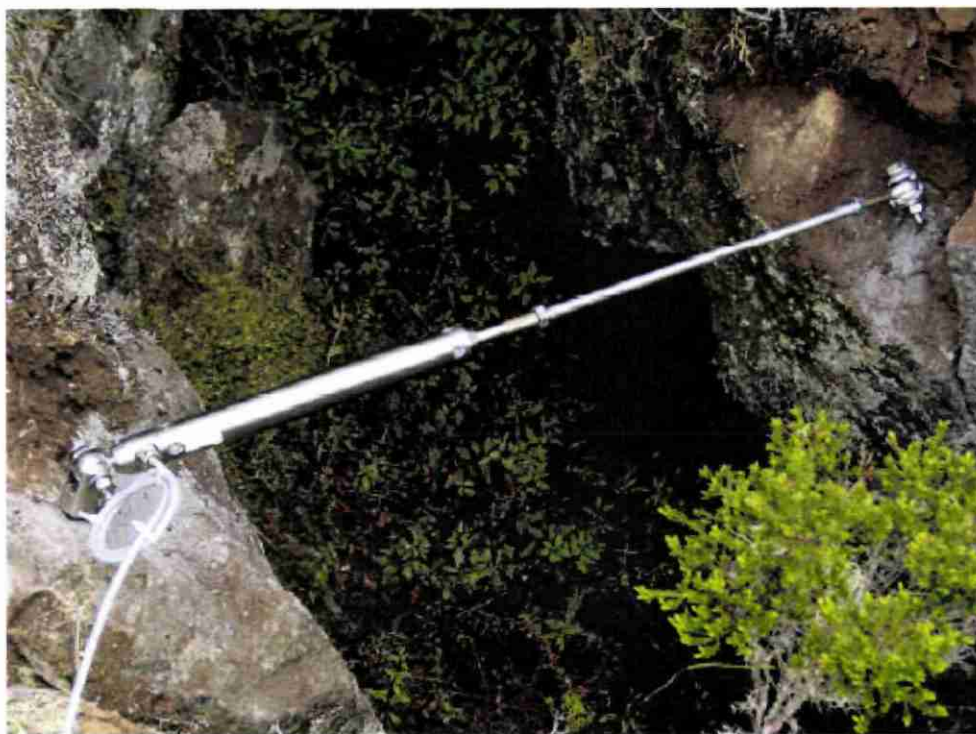
Illustration 23 – Exemple de capteur extensométrique en place
