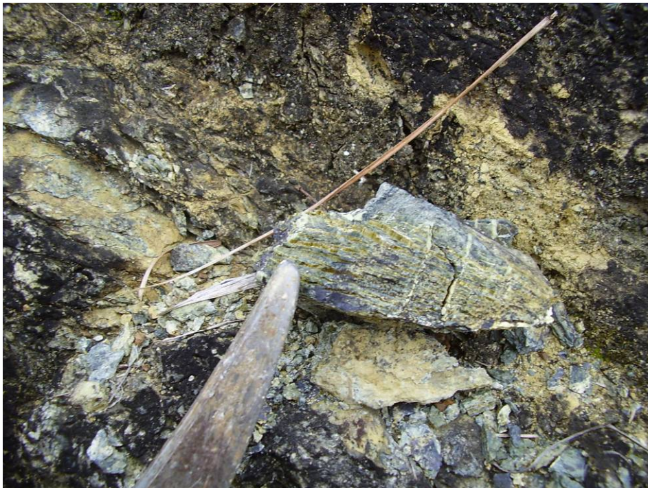
Photo 8 : Filonnets de chrysotile, route RT3-1, col de la Roussette, commune de Bourail
