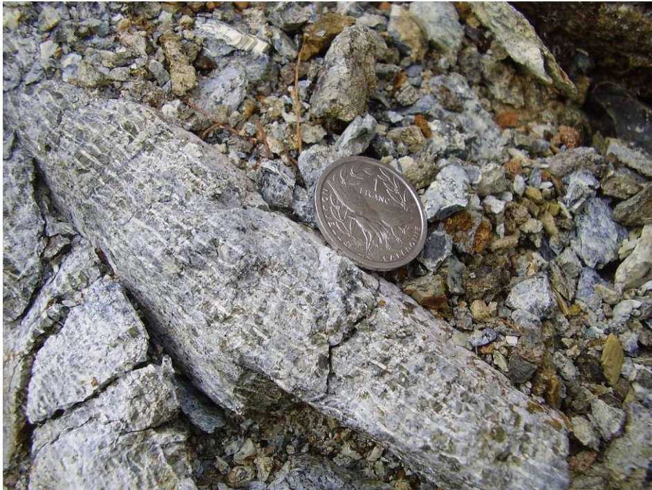
Photo 7 : Filonnets de chrysotile silicifié, massif de Koniambo, commune de Koné
