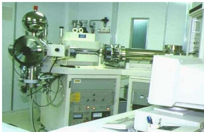
Figure 58 : Spectromètre de masse à source solide (TIMS).
