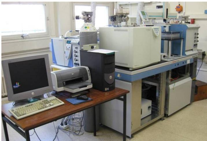
Figure 56 : Spectromètre de masse à source gazeuse (CF-IRMS).
