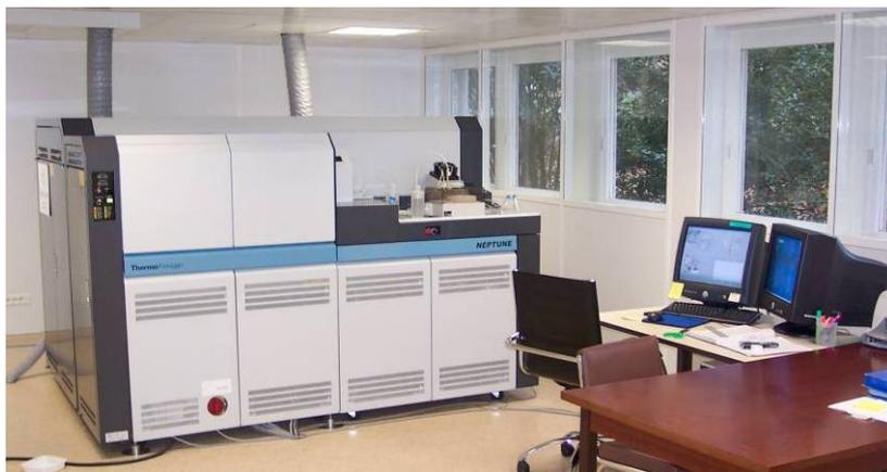
Figure 59 : Spectromètre de masse à plasma à couplage inductif et multi-collection (ICP-MS-MC).
