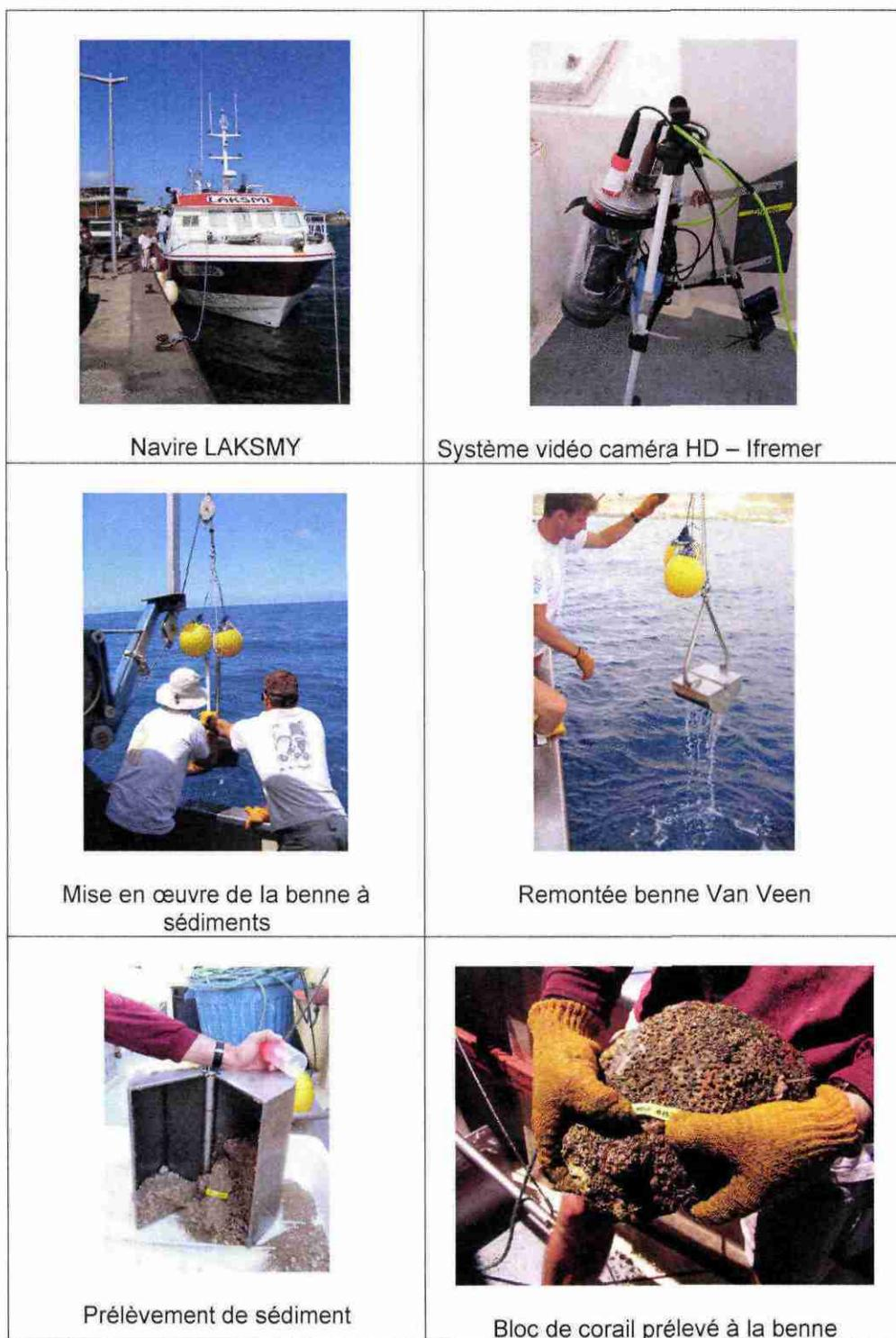
Illustration 10 – Navire et systèmes utilisés pour les prélèvements de sédiments et observations du fond
