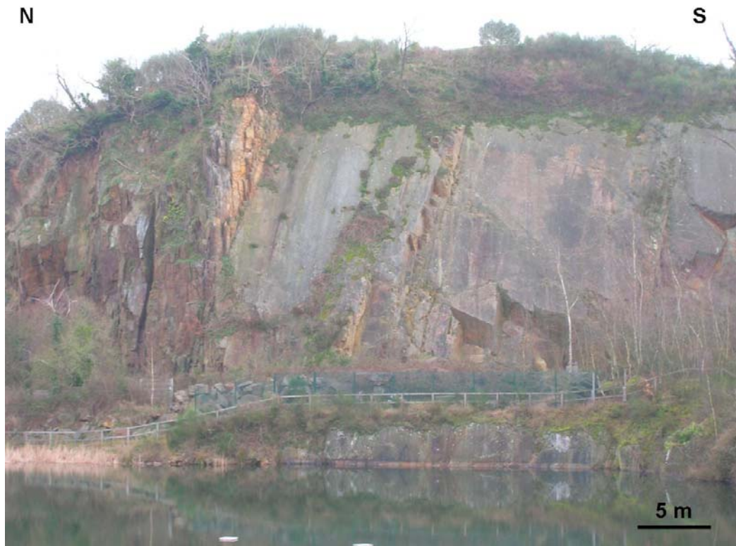
Figure 16 : Différence de pénétration de l'altération au sein des micaschistes (au Nord) et des faciès leptynitiques (au Sud) (Carrière des Chaudières, située dans la partie sud du territoire étudié)
