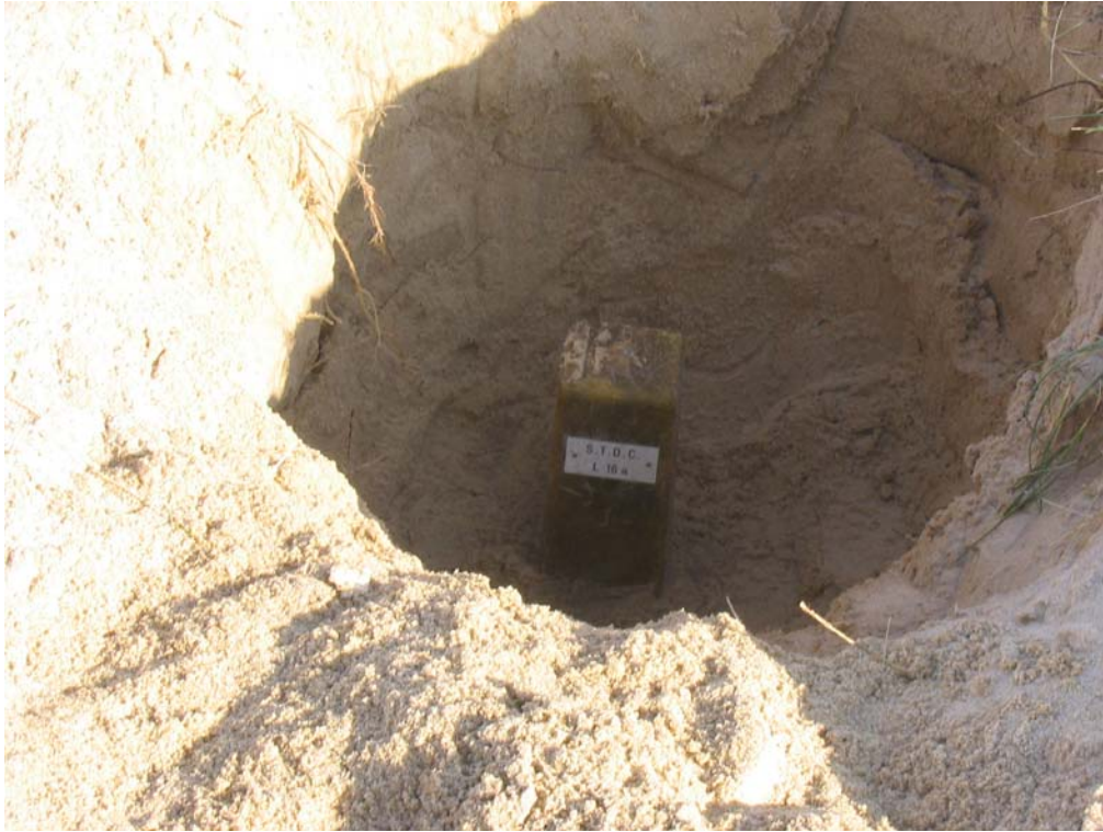
Figure 11 : Borne L16a ensablée sous 1.5 m
