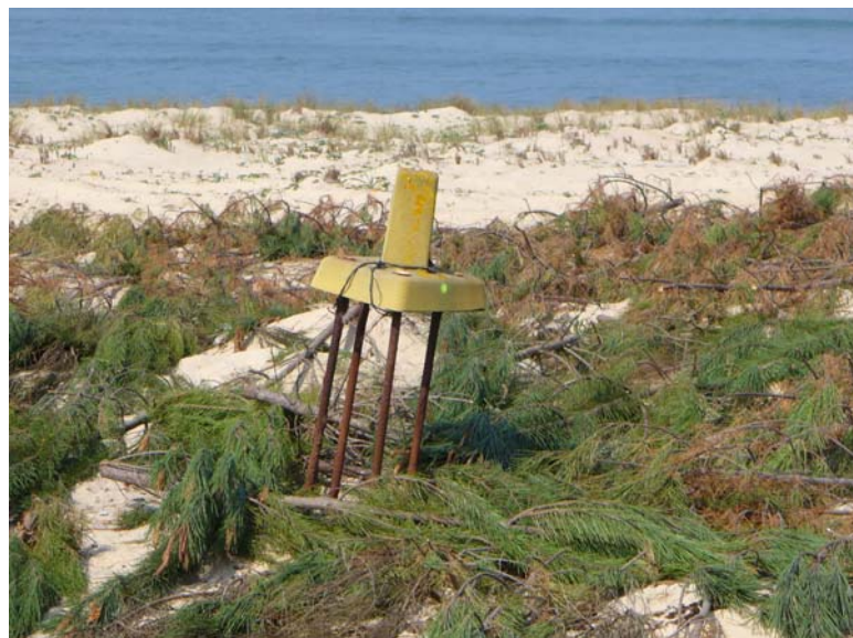
Figure 10 : Borne L11a en zone de travaux, sans doute déplacée
