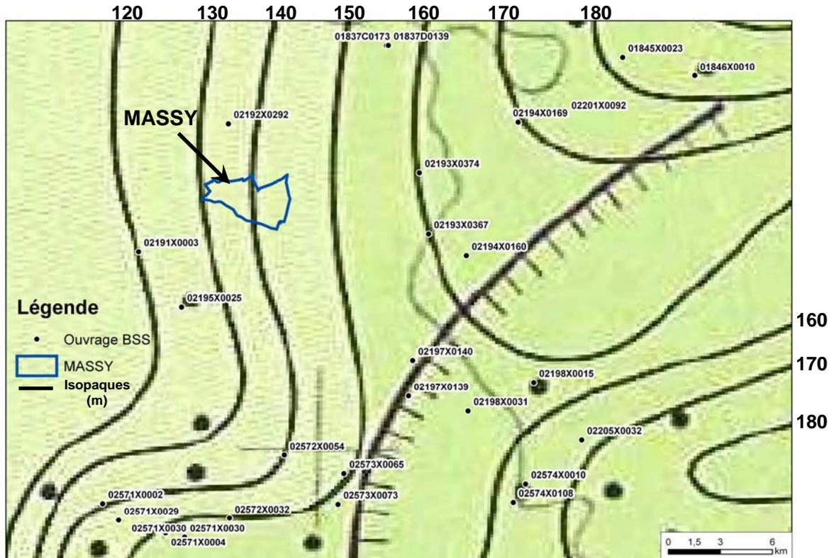
Figure 52 - Localisation des sondages BSS utilisés pour la description de la lithologie. Le fond de carte correspond à la puissance du réservoir (cf. Figure 51).
