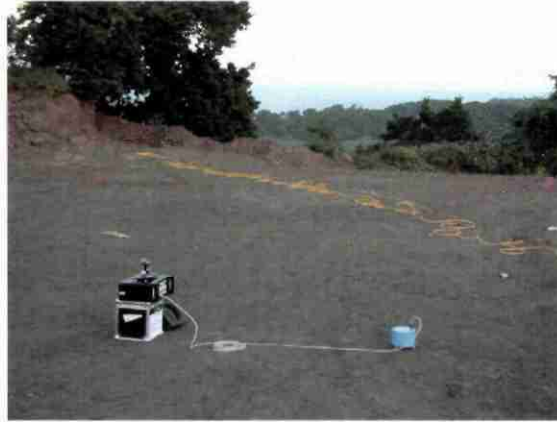
Figure 20 : Dispositif H/V (à gauche : la station d'acquisition et à droite : le sismomètre tridimensionnel 5 secondes)
