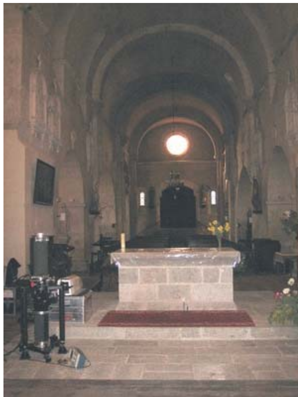
Figure 5 - Mesure absolue de pesanteur réalisée avec le FG5-228 du LDL dans la collégiale Saint Vincent du Mas d'Agenais, près de Tonneins
