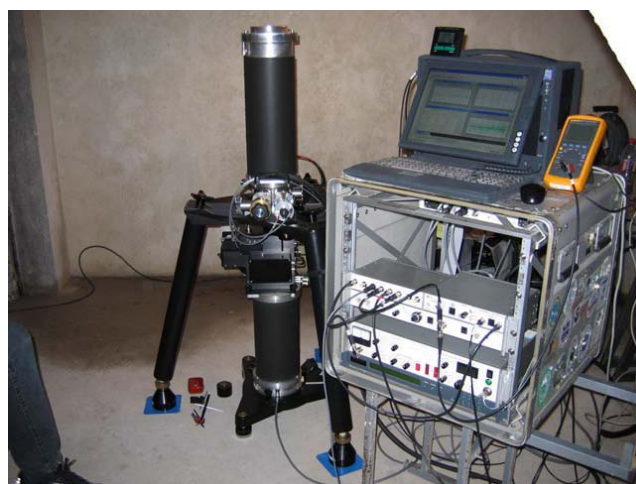
Figure 4 - Mesure absolue de pesanteur réalisée avec le FG5-206 de l'EOST dans les sous-sols du bâtiment de Génie Civil de l'IUT d'Amiens
