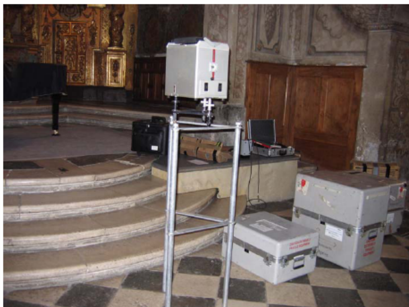
Figure 3 : mesure du gradient vertical à l'aide du Scintrex
