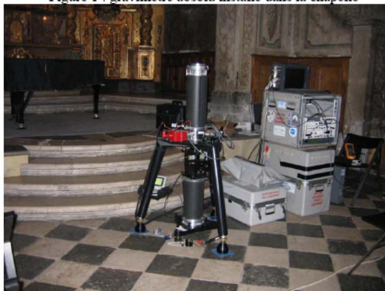
Figure 1 : gravimètre absolu installé dans la chapelle
