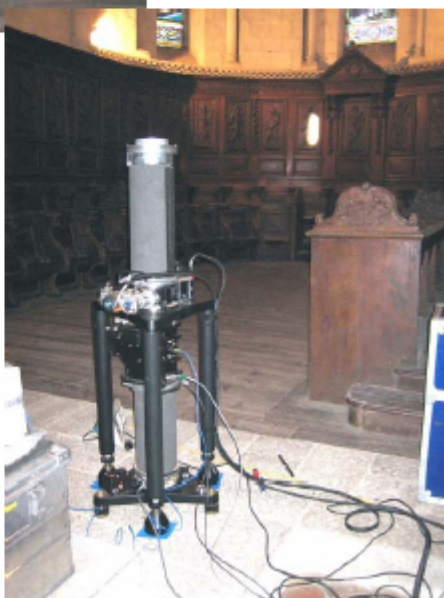
Photos 1&2 - FG5 en mesure dans la Collégiale
