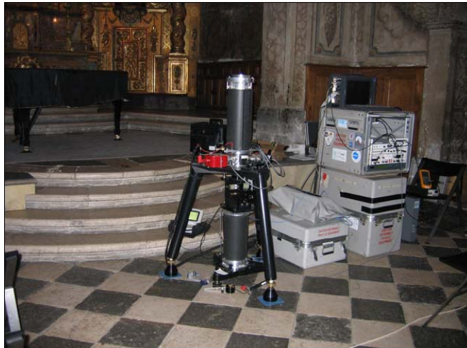
Figure 3 – Mesure absolue de pesanteur réalisée avec le FG5-206 de l'EOST dans la chapelle Sainte-Marie-du-Haut du Musée Dauphinois, à Grenoble
