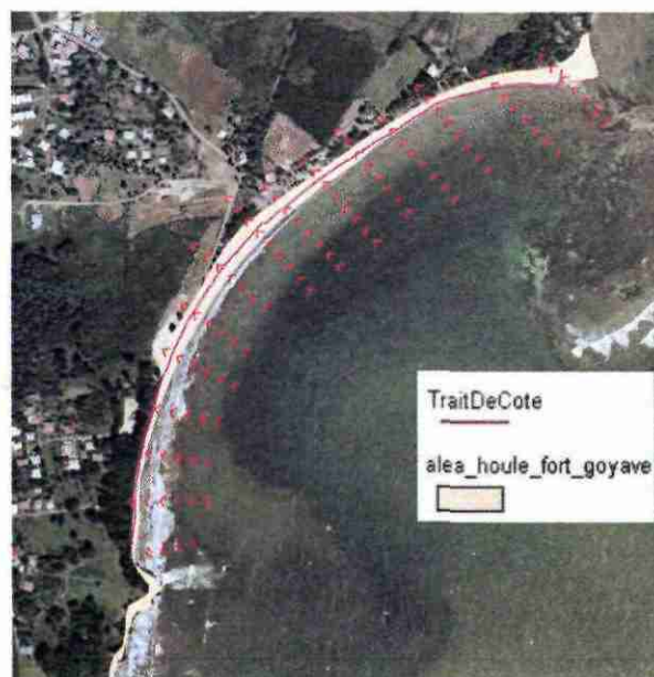
Figure 8 : Zonage de l'aléa houle cyclonique sous-dimensionné dans le PPR de Goyave. Les surverses sont représentées par les flèches rouges.
