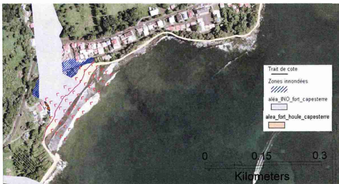
Figure 6 : Zone affectée par la houle et mal prise en compte dans le PPR de Capesterre (Bananier). Les surverses sont représentées par les flèches rouges.
