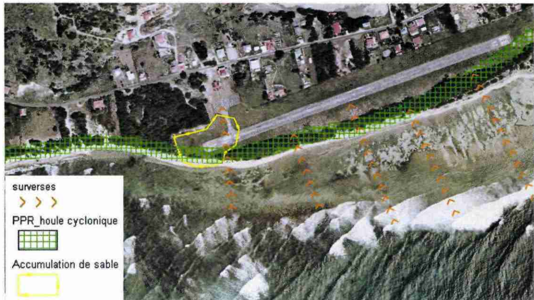
Figure 9 : Zonage de l'aléa houle cyclonique sous-dimensionné dans le PPR de la Désirade.
