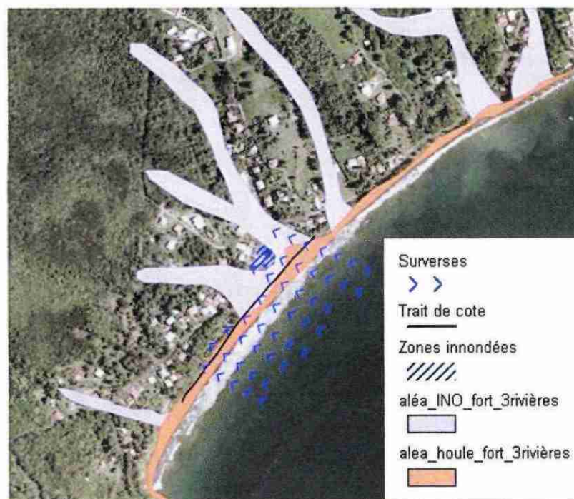
Figure 2 : Zone affectée par la houle et mal prise en compte dans le PPR de Trois Rivières (Gde Anse).
