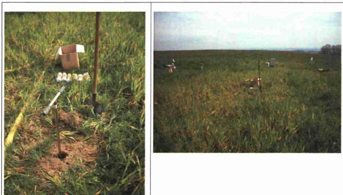
*Illustration 34 : Prélèvements de sol pour la détermination des humidités pondérales*
