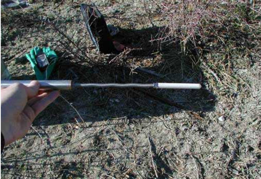
*Figure 7 - Capteur extensométrique installé à 0,5 m à Mormoiron équipé de sa cale de prolongement*
