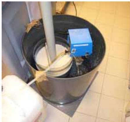
*Illustration 20 – Cuve placée dans un bain-marie pour mesurer la permittivité à des températures supérieures à la température ambiante*
