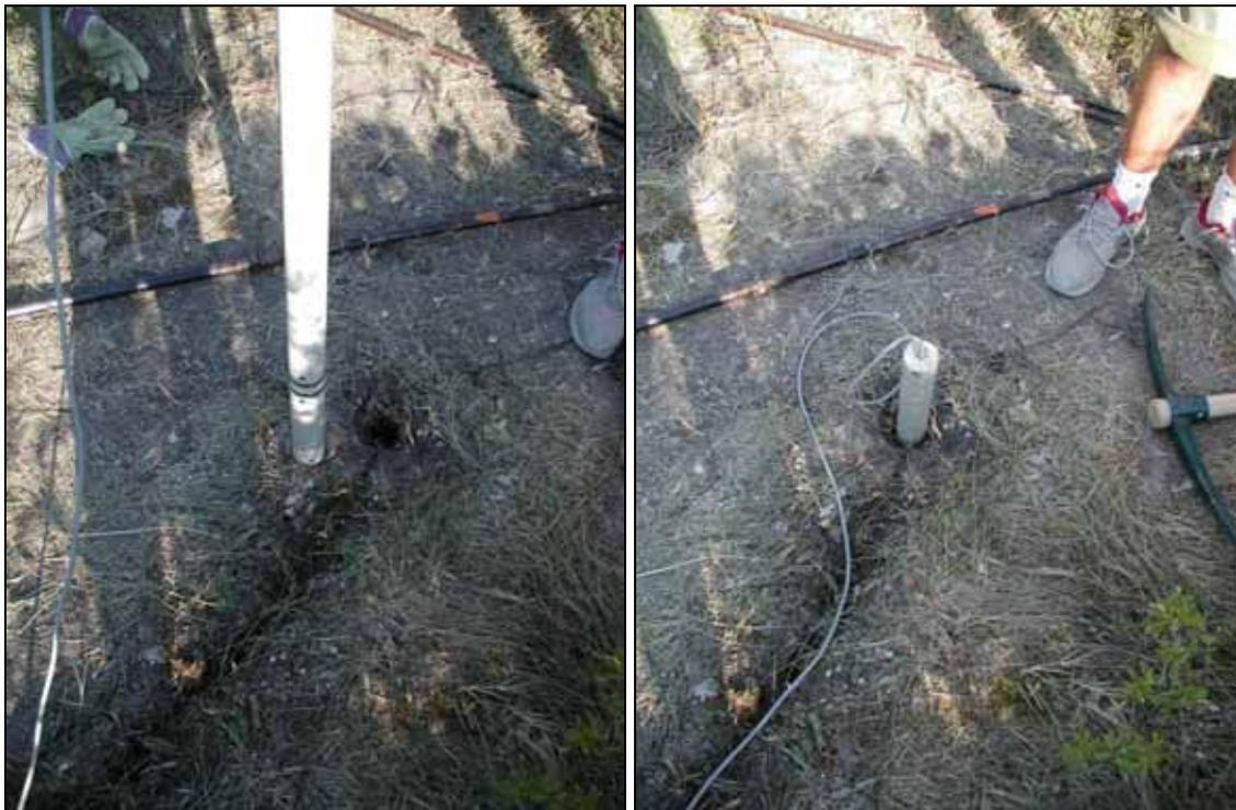
*Figure 2 – Implantation du capteur Humitub étalon à Mormoiron*
