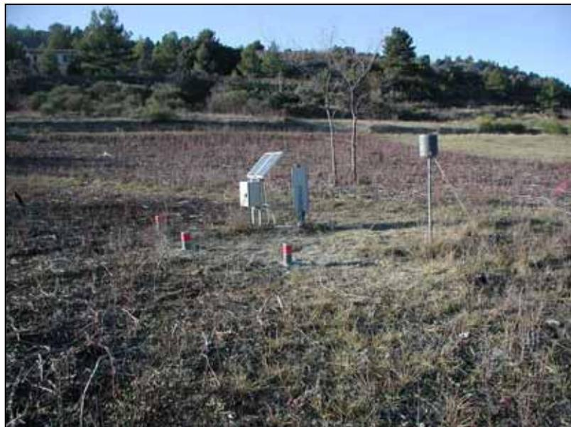
Figure 9 - Aperçu d'une partie du site (canne 2, armoire électrique principale, panneau solaire, pluviomètre, extensomètres)
