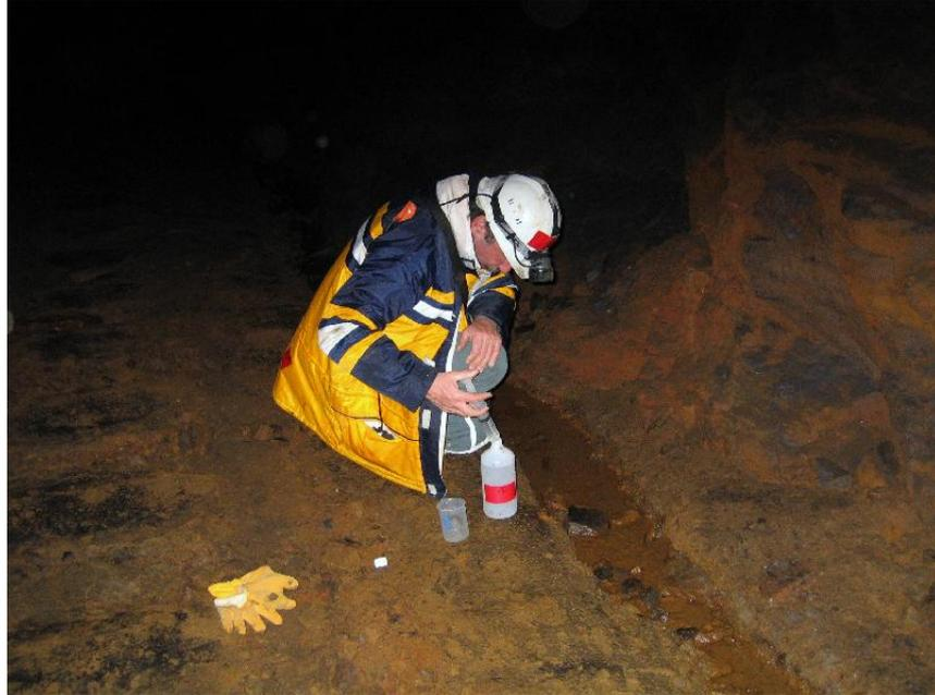
*Figure 14 : Prélèvement d'eau pour analyse chimique au point d'observation S5*
