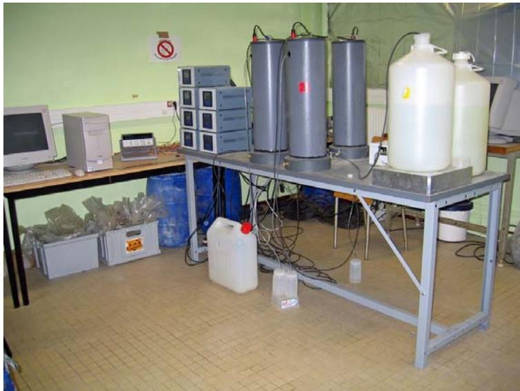
**Figure 4 : Dispositif expérimental de lixiviation en laboratoire**
