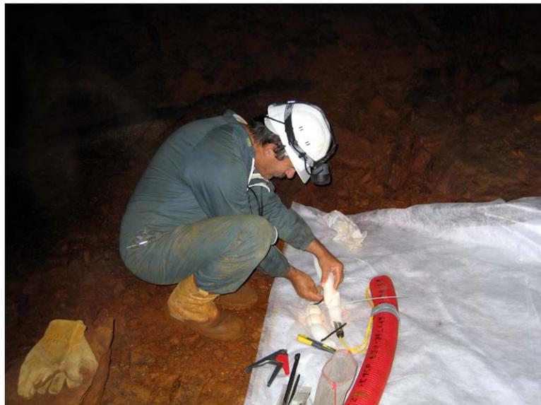
**Figure 12 :** Mise en place de la sonde de mesure de la conductivité de l'eau au point d'observation S3
