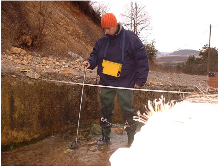
Illustration 6 - Jaugeage au micromoulinet de la source du Sabot.
