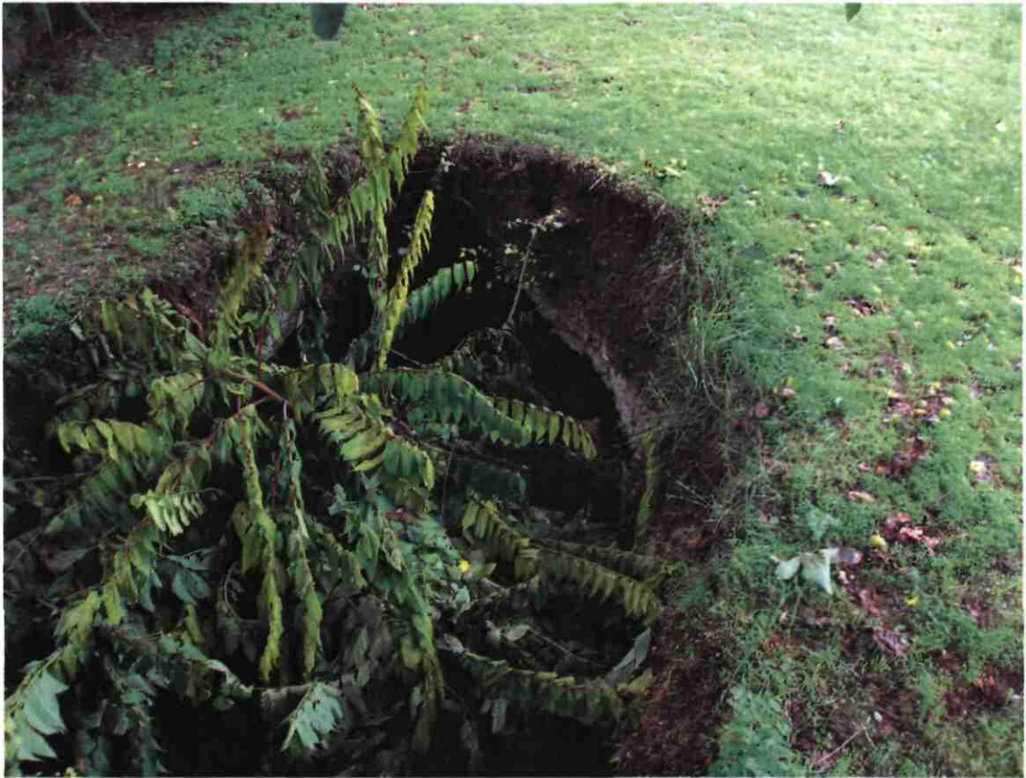
illustration 5 – Photo d'un fontis débouchant dans la cavité n°46
