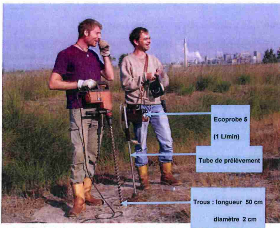
Figure 8 : Equipement d'analyse de gaz Ecoprobe 5
