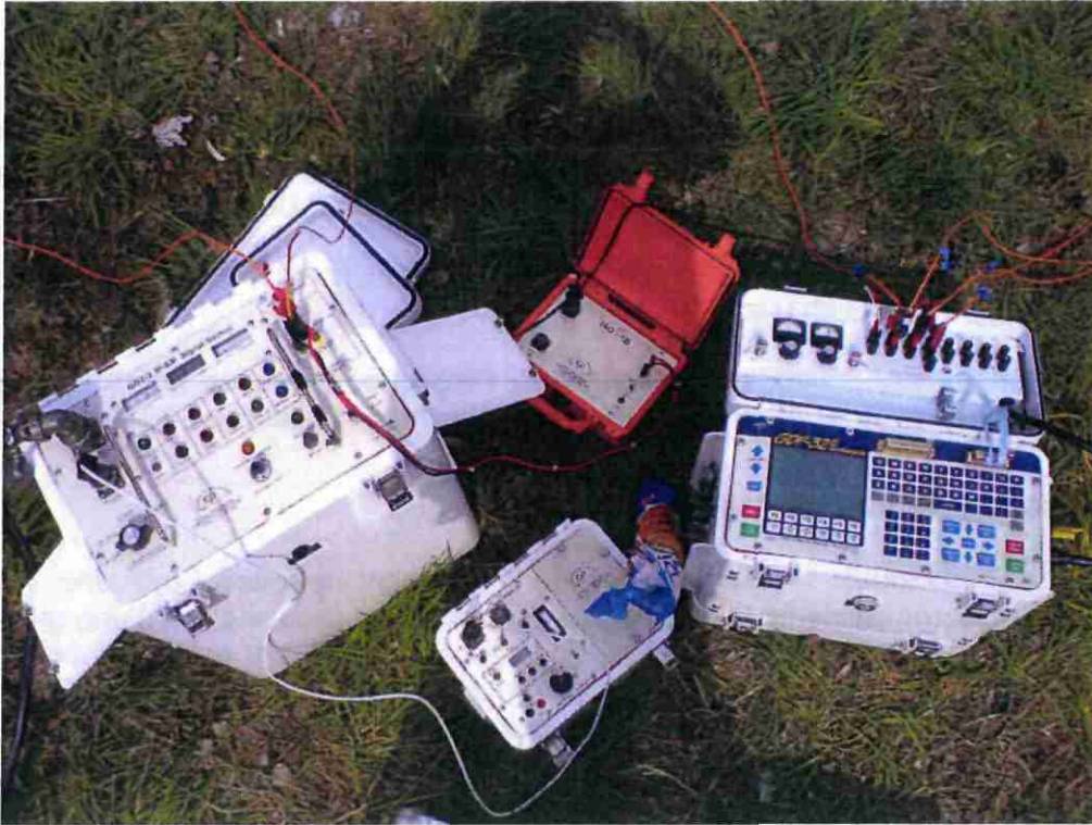
Figure 10 : Système d'injection Zonge GGT3 (à gauche) et de réception GDP32 (à droite).
