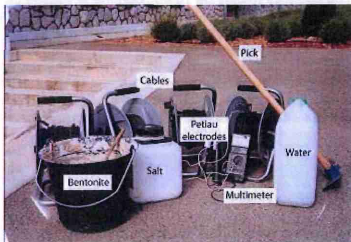
Figure 1 : Equipement de potentiel spontané : les électrodes, le multimètre, les câbles, eau, sel et bentonite pour améliorer le contact électrique des électrodes si nécessaire
