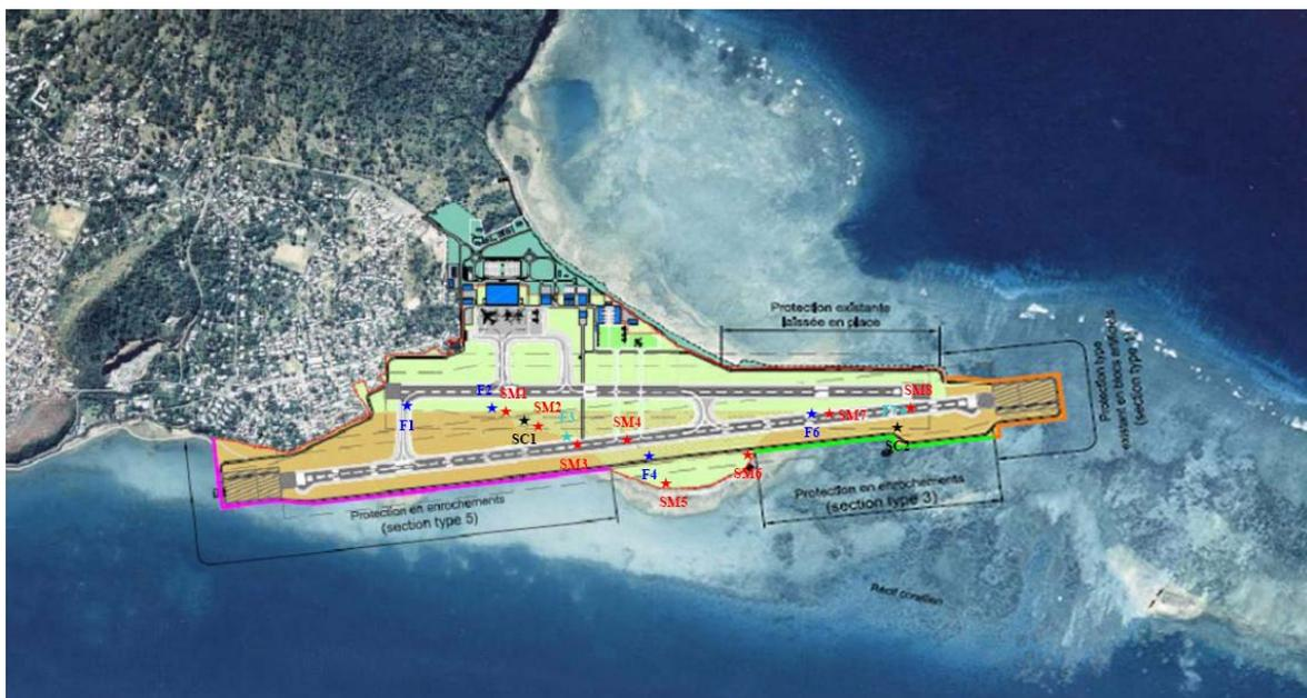
Illustration 5 - Emplacement des sondages sur terre : 2 sondages carottés (SC1 et SC2), 4 sondages destructifs (F1, F2, F4 et F6), 2 sondages pressiométriques (F3 et F7) et 8 sondages à la pelle (SM1 à SM8).
