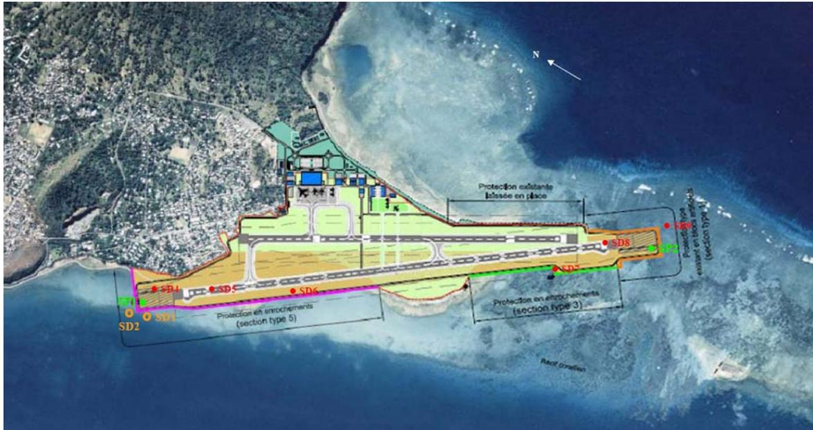
Illustration 4 - Emplacement des sondages en mer : 2 sondages pressiométriques (SP1 et SP2) et 8 sondages destructifs (SD1 à SD9 - pas de SD3).
