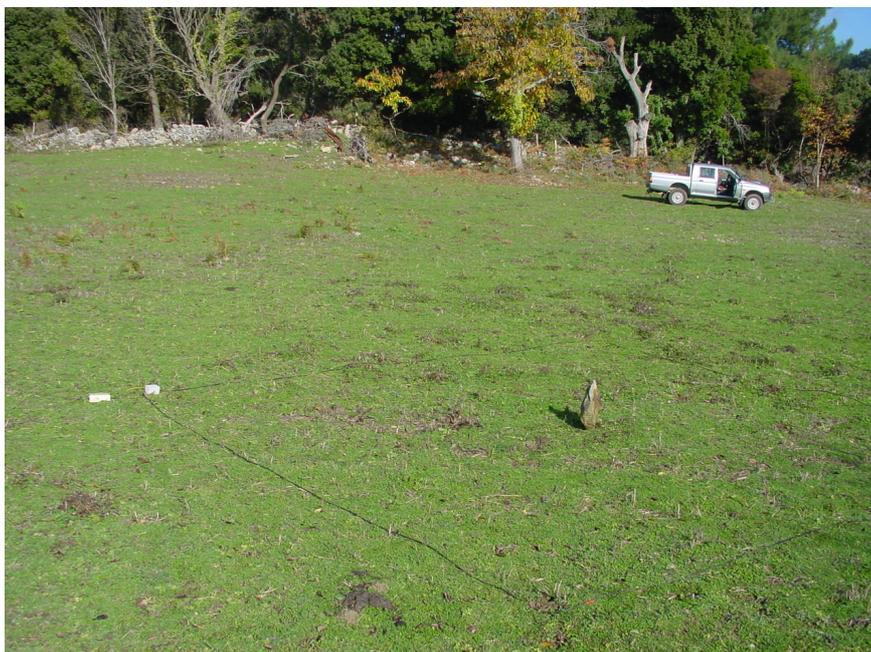
*Illustration 16 - Cable disposé au sol, formant l'antenne d'émission et de réception du signal. Ici, il s'agit d'un carré de 3 m de côté centré sur le caillou, uniquement à des fins d'illustration.*
