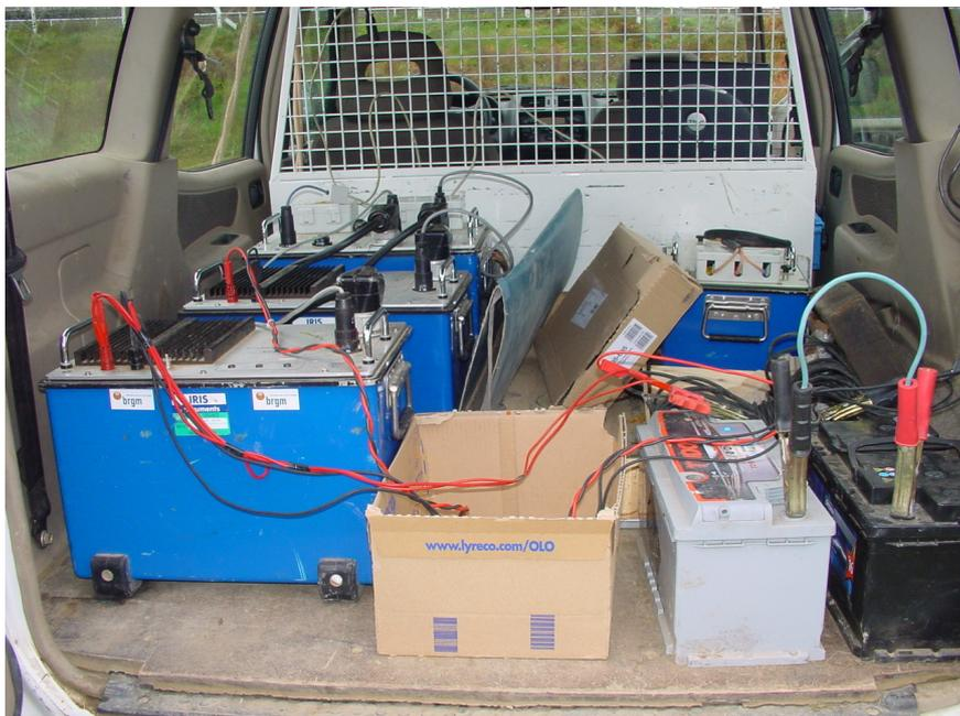
*Illustration 15 - Equipement de RMP NUMIS installé sur la plage arrière d'un 4x4 pour une manipulation aisée.*
