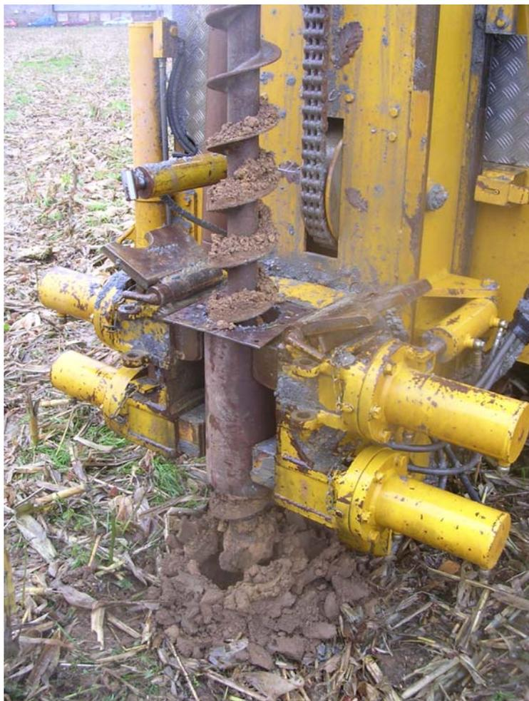
*Illustration 16 - Tige hélicoïdale en diamètre 150 mm et remontée des déblais*
