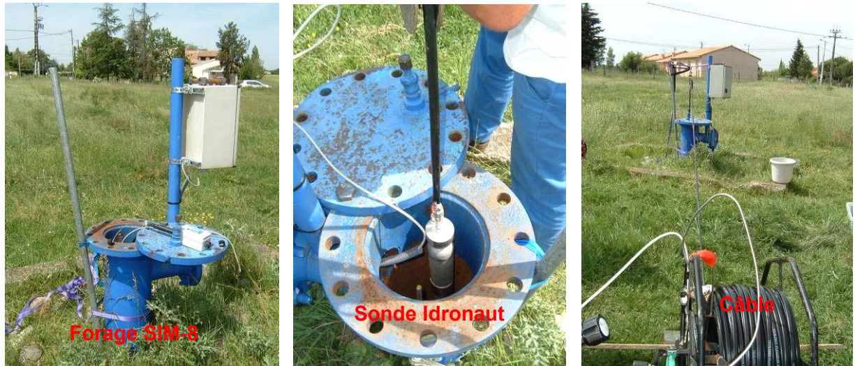
Illustration 28 : campagne de prélèvement de mai 2006 ; descente d'une sonde Idronaut dans le forage SIM-8 (N° BSS : 10098A0004)
