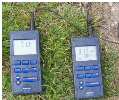
Illustration 44: boîtiers pour mesure du potentiel rédox et de la conductivité
