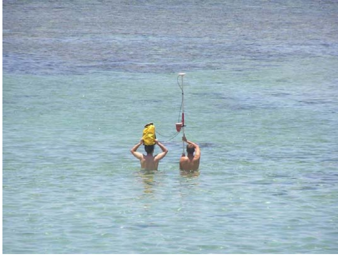
Illustration 6 – Levé topographique des zones arrière-récifales peu profondes au DGPS
