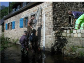
Tarage de l'échelle réalisé par le BRGM et l'IFREMER
