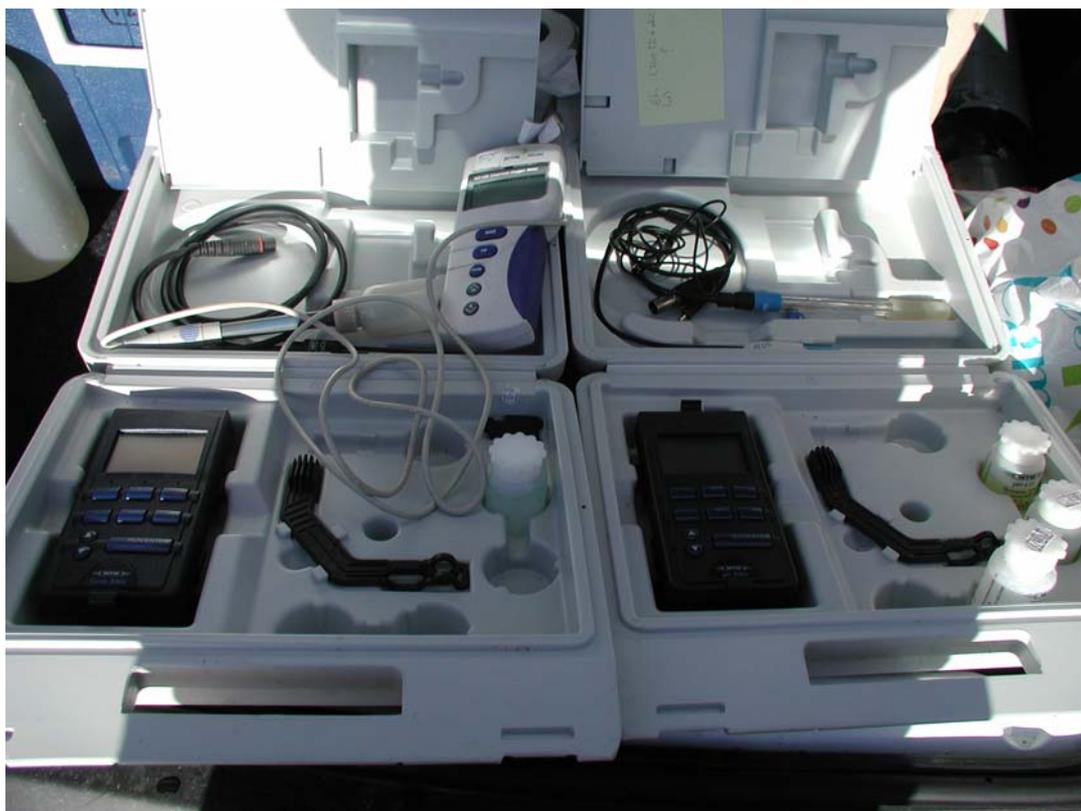
*Sondes de mesures du pH, de la conductivité, du potentiel Redox et de l'oxygène dissous*
