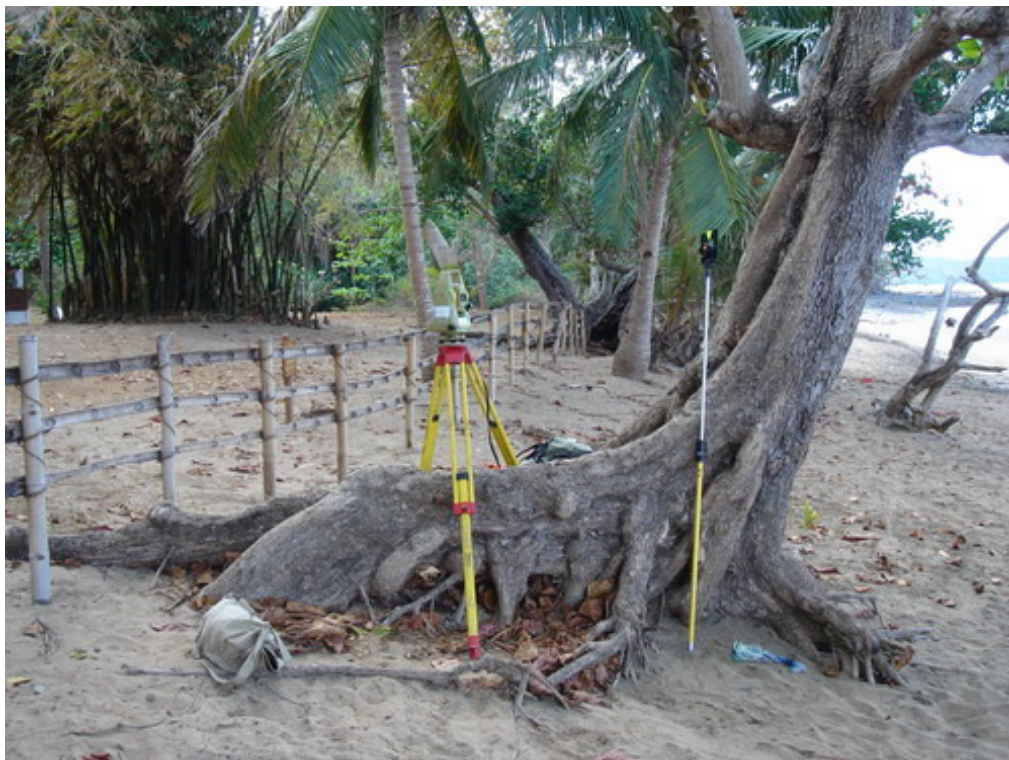
Illustration 3 – Tachéomètre laser Leica TC 407 et sa mire (septembre 2005 – mission BRGM/GEODAL)
