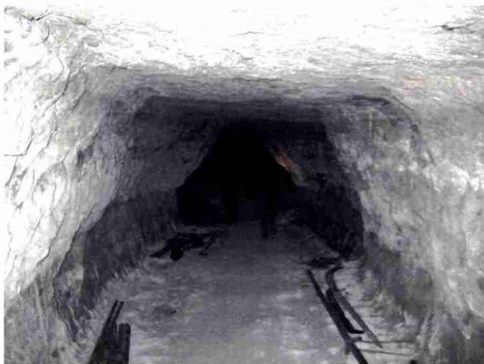
Illustration 3 – Galerie traçante exploitée pour la chaux – rue du chemin Blanc chez Monsieur Dupré
