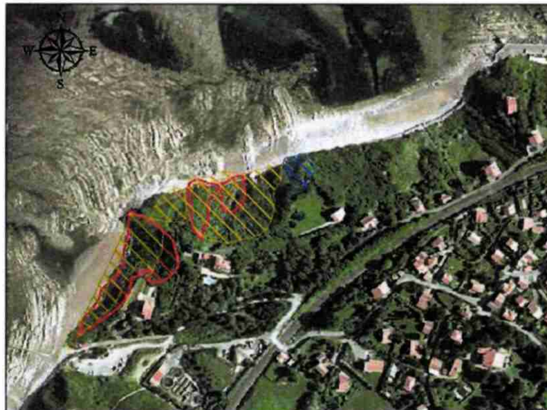
Figure 26 : Glissements de terrains répertoriés sur le secteur de Guéthary (fond cartographique : © ORTHOLITTORALE, 2000)
