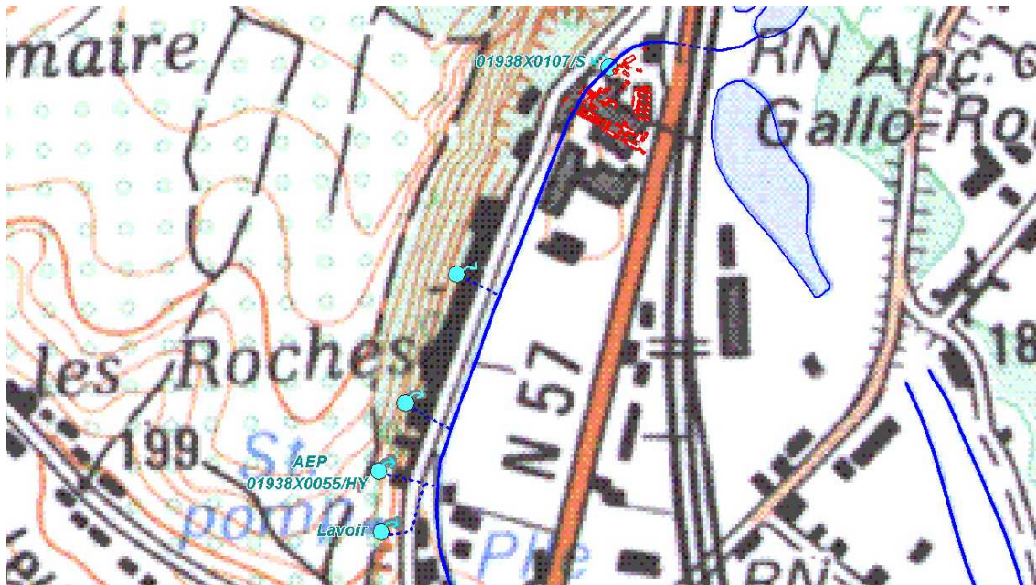
Illustration 5 : Résurgences de la nappe du Dogger à proximité du site UFP (échelle ~ 1/5 500 e ).
