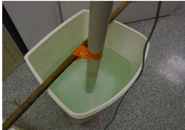
Illustration 41 – Étalonnage de la canne Humitub dans un bac d'eau distillée
