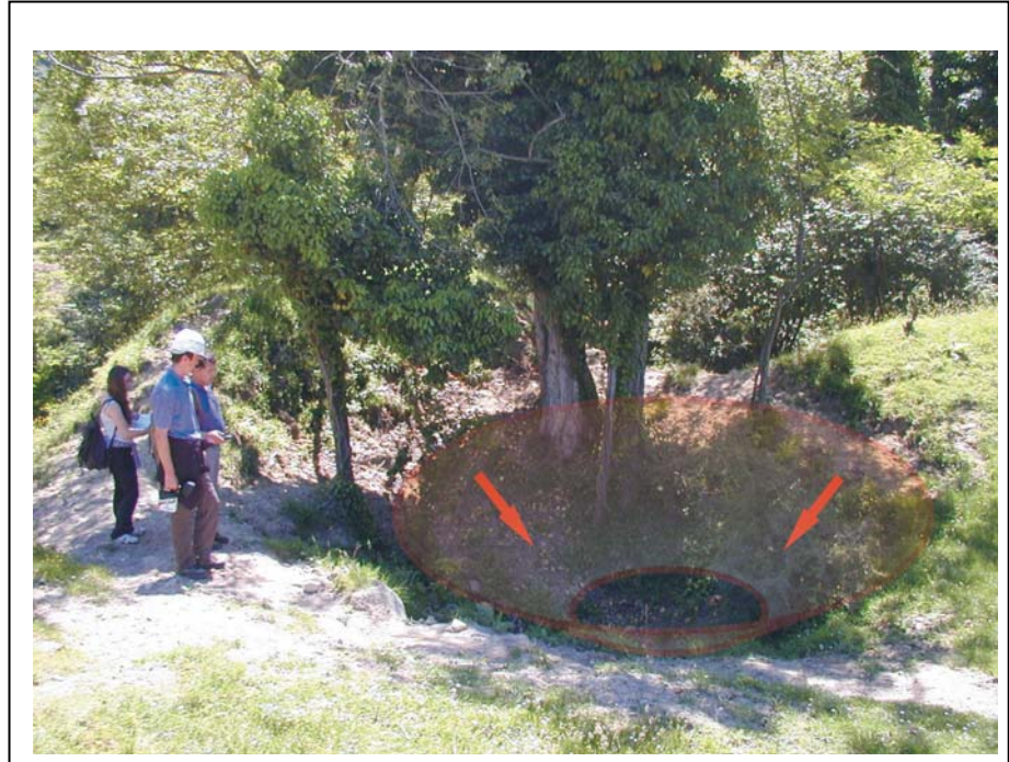
Illustration 10 - Exemple de fontis associé à une carrière de Gypse (Prat-Bonrepeaux).
